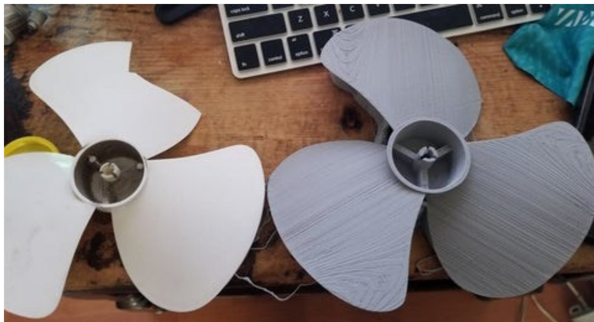
Rys.24 Reprodukacja wirnika z zastosowaniem technologii addytywnej. Źródło
