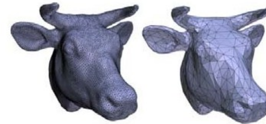
Rys.5 Wpływ zagęszczenia i jakości siatki na dokładność odwzorowania geometrii obiektu 3D. Źródło: [1] , [2]
