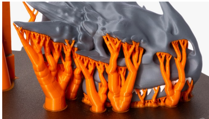
Rys.6 Podpory i orientacja modelu w druku 3D. Źródło: [1] , [2]
