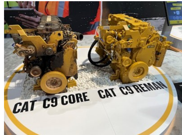
Rys.5 Porównanie silnika bazowego (core) oraz silnika po remanufakturze (reman). Źródło
