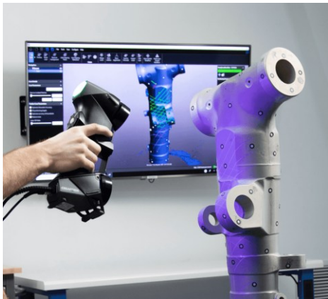
Rys.11 Wybrane technologie pomiarowe wykorzystywane do pozyskiwania geometrii obiektów w inżynierii odwrotnej.
