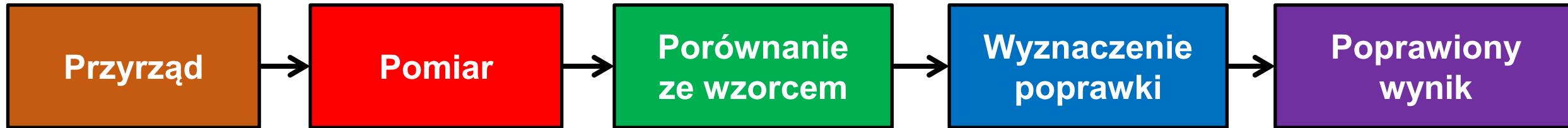
Rys.7 Etapy procesu korekcji wyniku pomiaru
