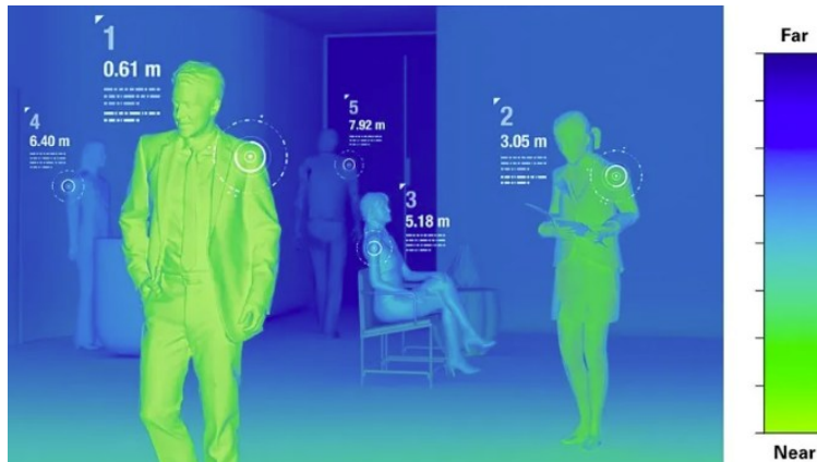
Rys.20 Mapa głębi rejestrowana przez kamerę ToF. Źródło
