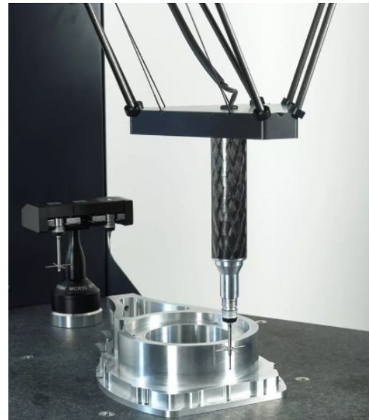
Rys.12 Współrzędnościowa maszyna pomiarowa podczas pomiaru detalu. Źródło
