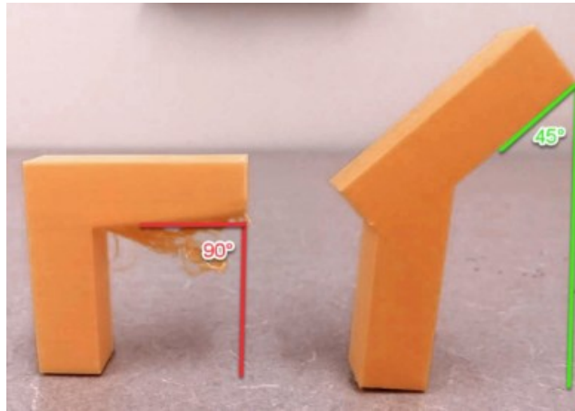
Rys.5 Kąt nawisu a potrzeba stosowania podpór. Źródło: [1] , [2]
