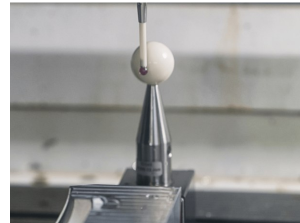
Rys.16 Głowica pomiarowa z końcówką stykową Źródło
