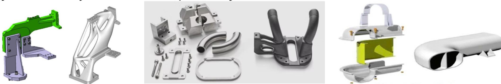
Rys.13 Przykłady konsolidacji części w projektowaniu pod technologie addytywne. Źródło: [1] , [2] , [3]
