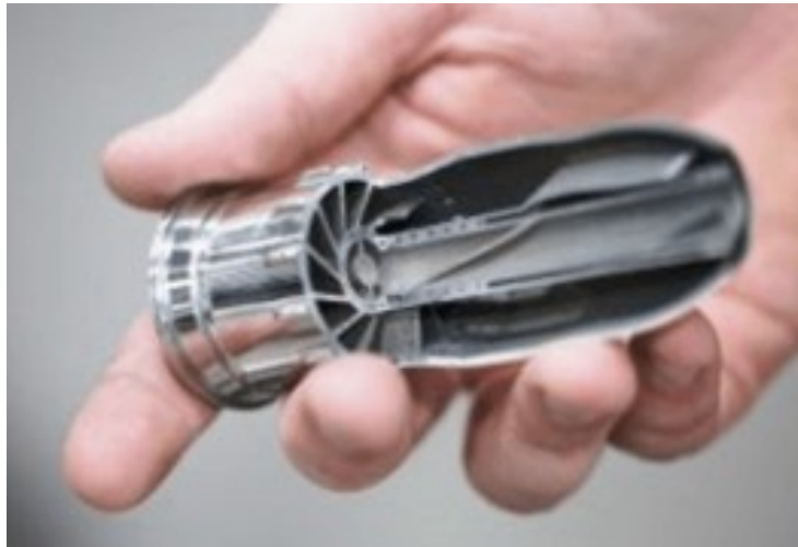
Rys.14 Złożona geometria wewnętrzna w druku 3D. Źródło: [1] , [2]
