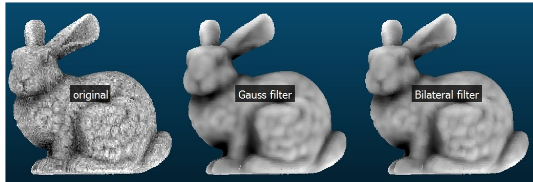
Rys.35 Wpływ filtracji i odszumiania na jakość chmury punktów oraz rekonstruowanej powierzchni 3D. Źródło: [1] , [2]
