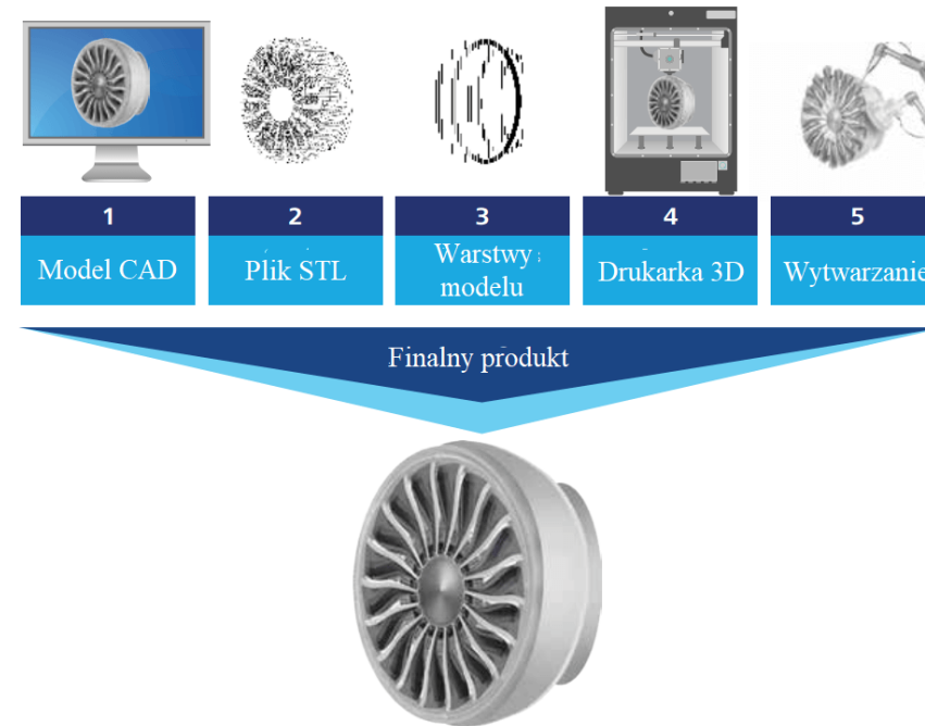
Rys.1 Schemat procesu wytwarzania przyrostowego: od modelu CAD do finalnego produktu. Źródło
