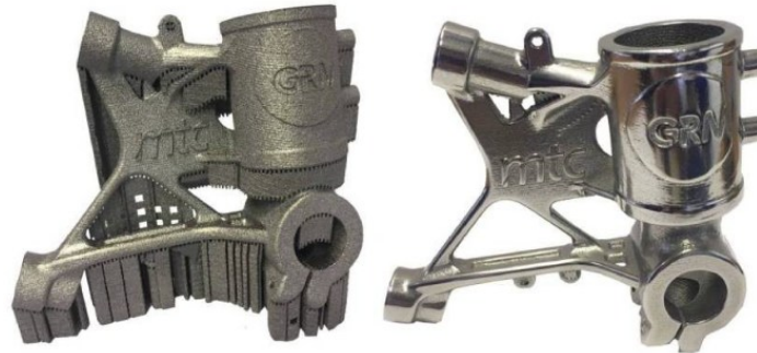
Rys.15 Post-processing elementów drukowanych 3D. Źródło: [1] , [2] , [3]
